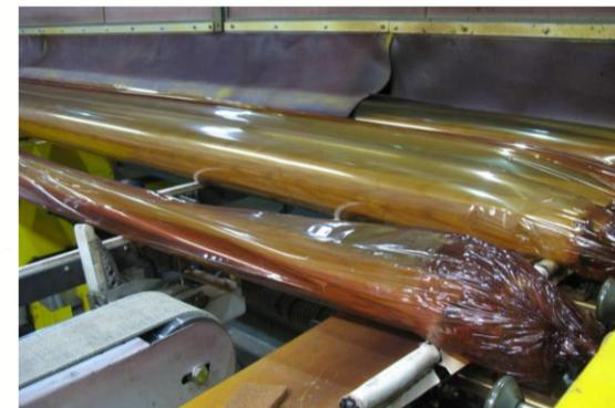
Profili all'uscita dal forno: il film esausto viene staccato dalla superficie del profilo soffiando aria nell'imbustamento.
