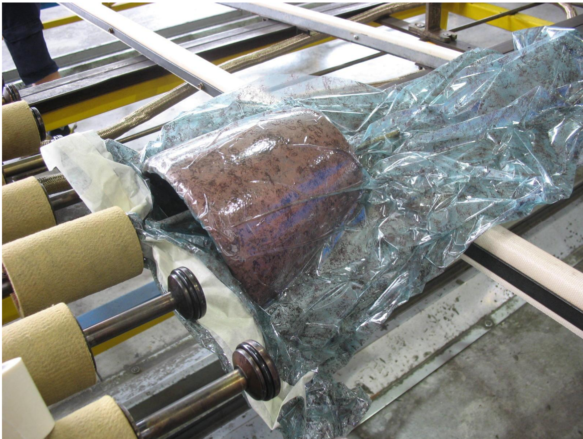
Εικόνα 9: Το βάζο μέσα στο φάκελο πρέπει να είναι κολλημένο στις κεφαλές αναρρόφησης κενού.
