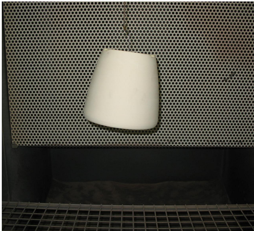
Εικόνα 1: Προετοιμασία του δείγματος με τρόπο που να μπορεί να γυρίσει ή να μετακινηθεί μόνο με το γάντζο
