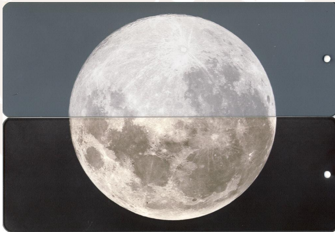
Η αποτύπωση που εφαρμόζεται πάνω στο λαμαρινάκι με ένα χέρι πούδρας DS 434 (πάνω) και διπλό χέρι PE411 + DS 407 (κάτω)
