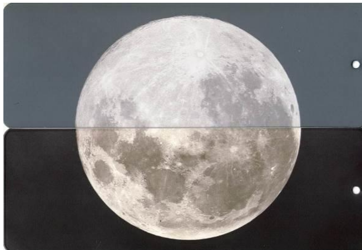
Foto 1: Stampa plotter applicata su lamierino singola mano DS 434 (sopra) e su doppia mano PE411 + DS 407 (sotto)
